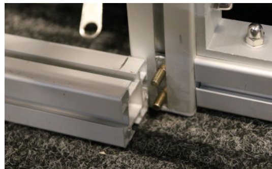
*8 - Använd en tving om det är svårt att få tvärstagen på plats.
