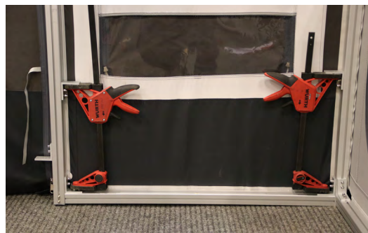
*1 - Spänn upp frontväggen sektionvis med att sätta tvingarna på övre delen mellan tvärstaget och överliggaren.
