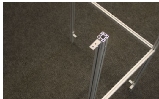
*6 - Förbered A-vinklarna. Placera de framför gavelbenen (sett utifrån).
